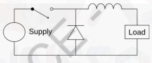
Fig. : Buck converter circuit diagram.
